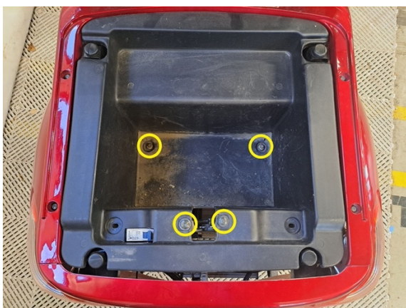
Irrota säilytyslokeron kiinnityspultit. (hylsy 8 mm).
